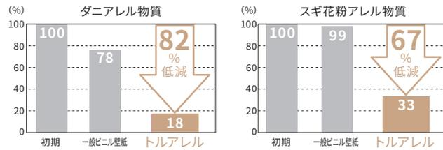
試験方法: ダニやスギ花粉のアレル物質溶液を壁紙表面に接触させ、一定時間後のアレル物質残存量をELISA法※にて測定。
