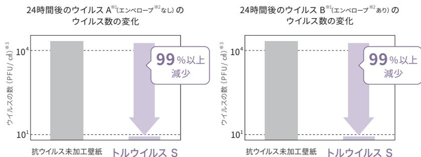
試験方法: ISO 21702法 試験ウイルス: ウイルス A<sup>※1</sup>(エンベロープ<sup>※2</sup>なし) ウイルス B<sup>※1</sup>(エンベロープ<sup>※2</sup>あり)
